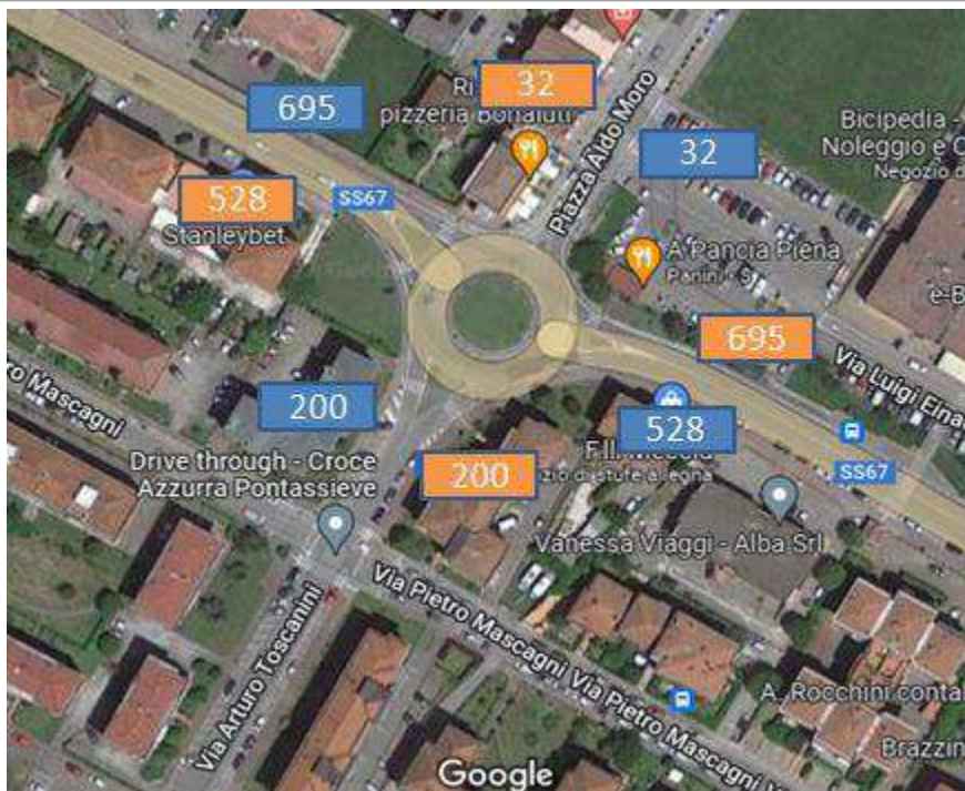
Figura 10- Flussi sulla rotatoria a 4 braccia S.S.67-piazza Aldo Moro-via Toscanini – fascia oraria di picco mattutina -stato attuale
