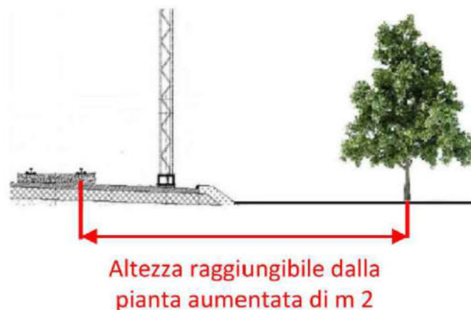
Fig. 3 - Distanza minima che deve esserci tra le piante di nuova piantagione e la rotaia più vicina
