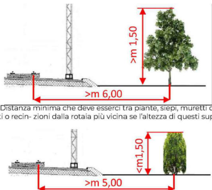
Fig. 2 - Distanza minima che deve esserci tra piante, siepi, muretti di cinta, steccati o recinzioni dalla rotaia più vicina se l'altezza di questi è inferiore a m 1,50
