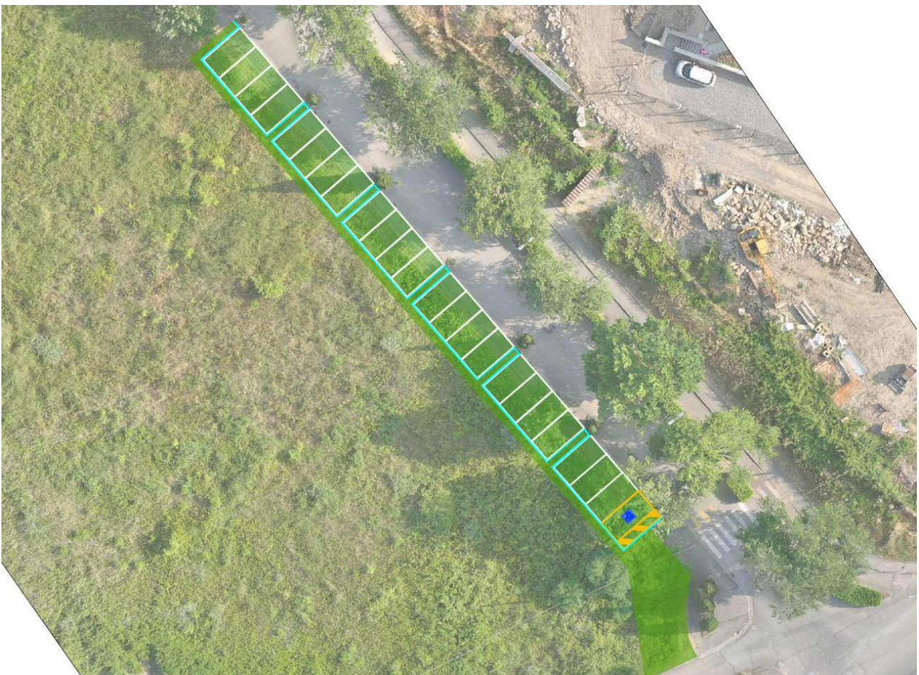
Figura 5 – Individuazione delle aree permeabili ed impermeabili
